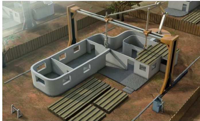
Figura 1 – Exemplo da técnica Contour Crafting (CC)
